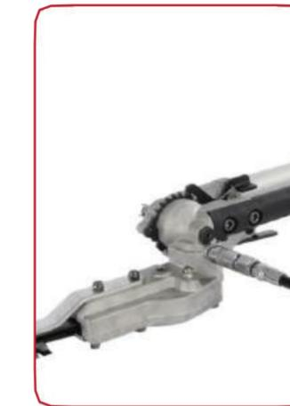
Connecter un pistolet graisseur compatible à la boîte de vitesses les graisseurs de l'assemblage.
