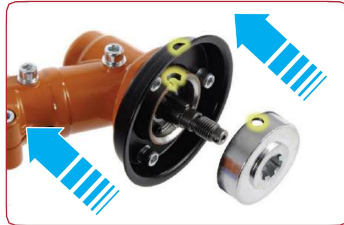
Aligner les trous du collier, de la rondelle "A" et de la essieu. Les domaines mis en évidence ci-dessus. Le but de ce est de permettre le serrage de la bobine ou de l'écrou de lame à 3 dents en bloquant l'axe, ceci est fait en insérant la clé allen à travers les trous surlignés ci-dessus.
