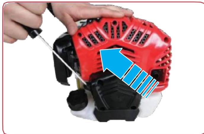
Placez l'appareil sur le sol et utilisez votre pied gauche pour fixer l'arbre au sol tout en utilisant votre main droite pour tirer la poignée du démarreur de recul vers l'extérieur jusqu'à ce que vous sentiez une tension.
