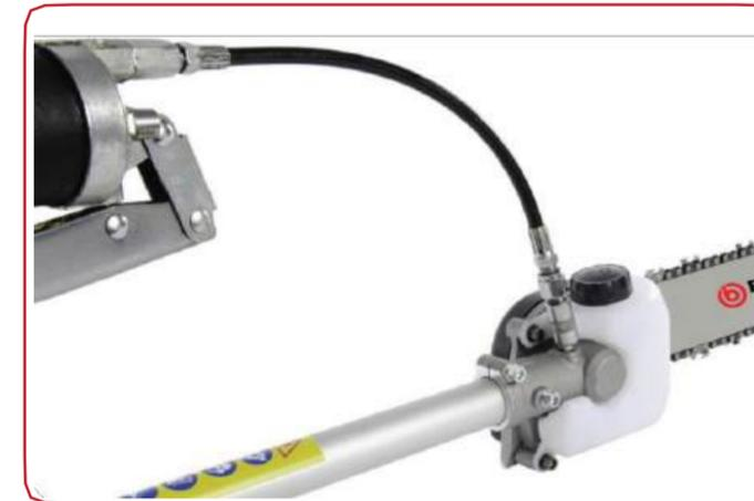
Connecter un pistolet graisseur compatible à la tronçonneuse le graisseur de la boîte de vitesses.
