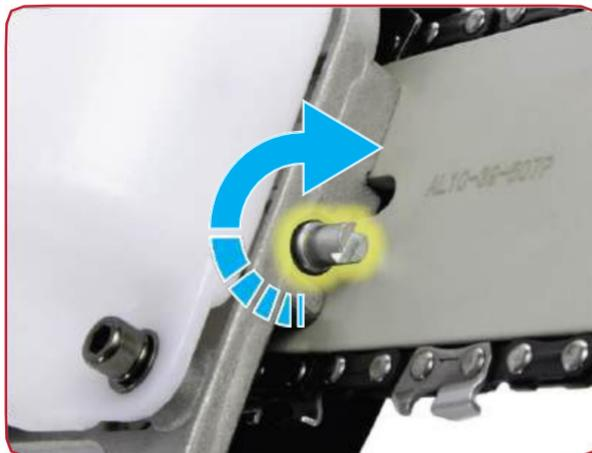
Tournez la vis de réglage de la tension de la chaîne dans le sens des aiguilles d'une montre jusqu'à ce que la chaîne tire sur le bas du guide.
