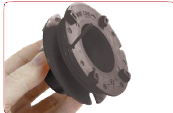
Fixez l'enroulement à l'intérieur de l'une des deux languettes pour saisir le cordon et l'empêcher de se dérouler.
