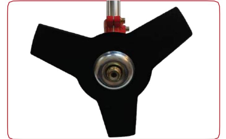
Verrouillez l'essieu en plaçant la clé allen dans le trou de positionnement du collier et serrez l'écrou de blocage à l'aide de la clé fournie, en tournant dans le sens inverse des aiguilles d'une montre jusqu'à ce qu'il soit bien fixé. (Suivez les étapes 8 et 9 de la section "Assemblage" sur la façon de verrouiller l'essieu).
