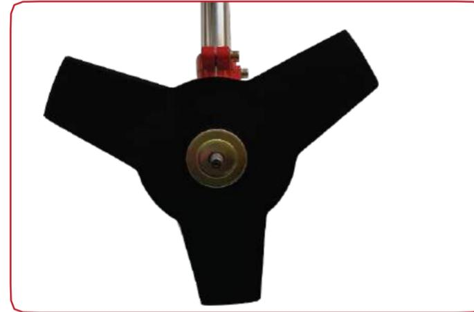
Il est important que la lame soit correctement positionnée dans la rondelle "A" et non pas dans une position décentrée qui pourrait causer des vibrations excessives et des dommages prématurés à l'arbre
