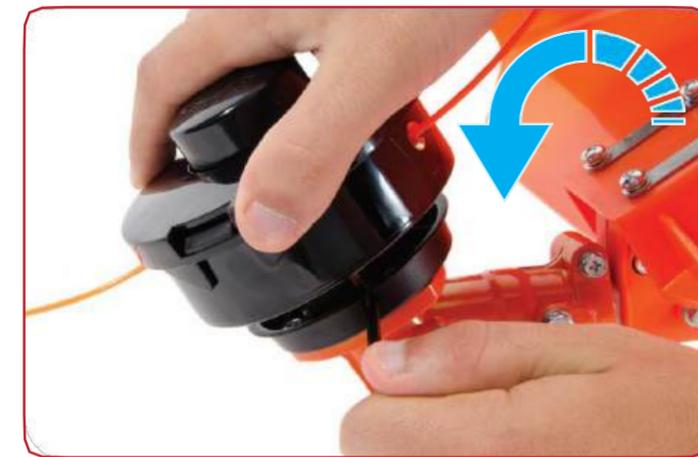
Verrouillez l'axe en plaçant la clé allen dans le trou de positionnement du collier et enroulez la bobine sur le fil en tournant dans le sens inverse des aiguilles d'une montre.
