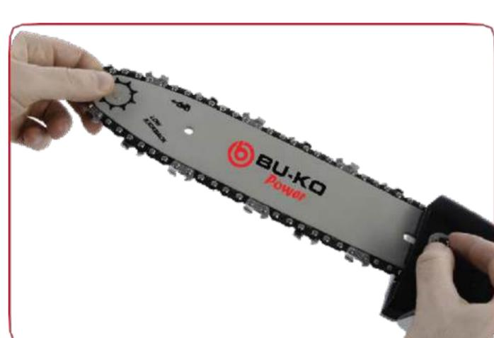
Remettez le couvercle du pignon d'entraînement en place. Tenez la pointe de la barre vers le haut, l'écrou doit être finger au maximum.
