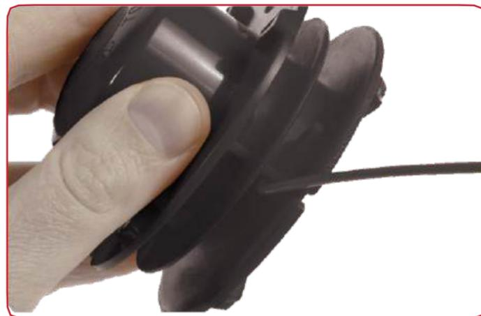
La cartouche se compose de deux enroulements qui doivent être enroulés dans le sens indiqué sur la corps. Fixez le fil de remplacement à la cartouche comme indiqué.
