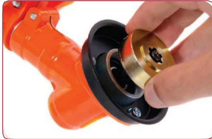
Installez la rondelle "A" comme illustré ci-dessus. Alignez le trou de la rondelle avec le trou du collier de la bobine.
