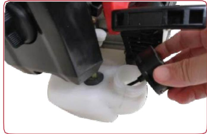
Enlever le bouchon du réservoir et fill le réservoir à plus que 80 % de la capacité.
