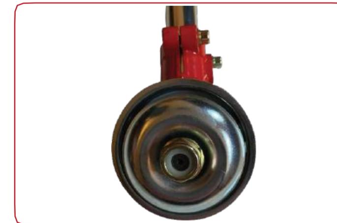
Les rondelles de blocage peuvent être pré-installées sur le moyeu de la machine.
