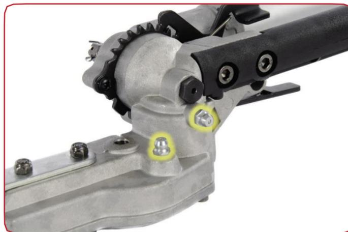
Los componentes dentro de la caja de engranajes del Cortador de Cercas deben trabajar muy duro y por lo tanto DEBEN permanecer bien lubricados en todo momento. Antes o después de cada uso.
