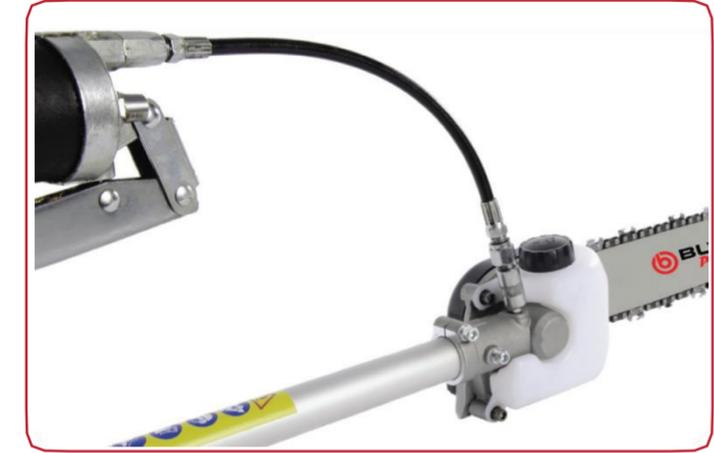
Conectando un engrasador compatible con la sierra lubricador de engranajes.
