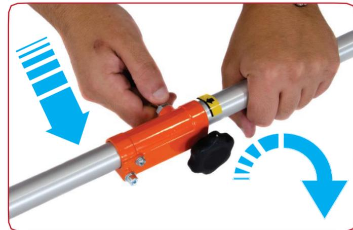
Rilasciare il perno e ruotare l'albero inferiore fino a quando il giunto non è bloccato in posizione.
