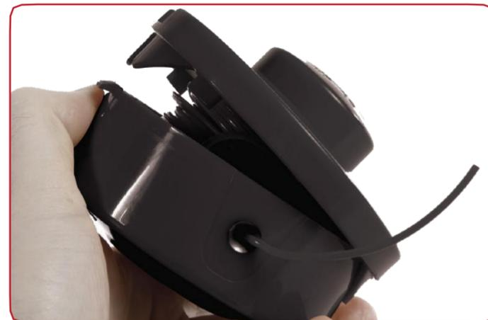
Repita los pasos 2 y 3 para el segundo bobinado y vuelva a pasar por los ojales. Asegure la tapa repitiendo el "Paso 1" al revés.
