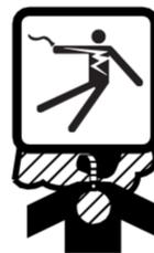
**ATTENZIONE!** Nunca toque la bujía o el cable de la bujía mientras el motor esté funcionando. Hacerlo podría resultar en una descarga eléctrica.
