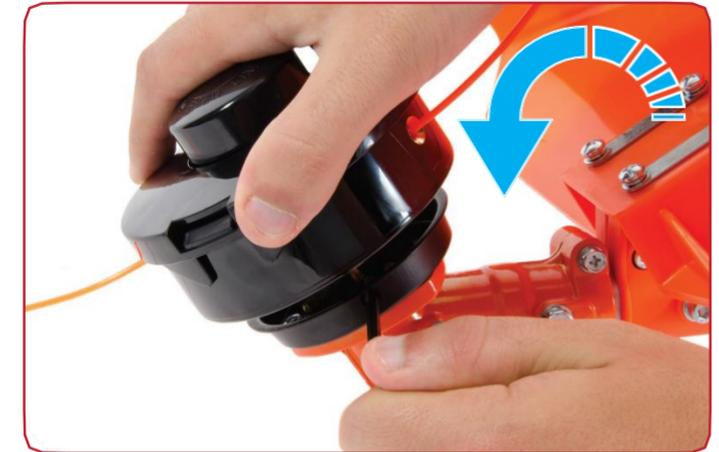
Bloccare l'asse posizionando la chiave a brugola all'interno del foro di posizionamento del collare e avvolgere la bobina sul filo ruotando in senso antiorario.
