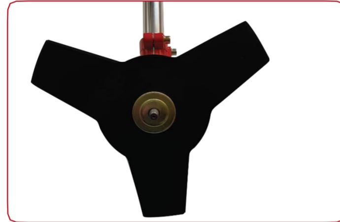
Instale la arandela "B" como se muestra arriba para asegurar la cuchilla al eje.
