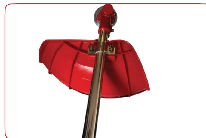
Coloca el protector en el eje inferior con el 2x tornillos proporcionados.
