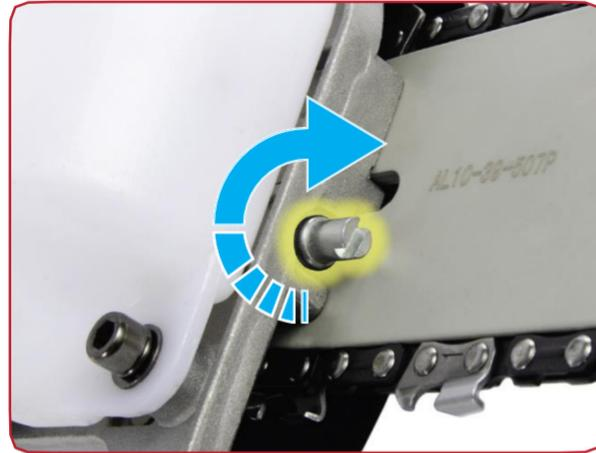
Gire el tornillo de ajuste de la tensión de la cadena en el sentido de las agujas del reloj hasta que la cadena se tense en la parte inferior de la barra.
