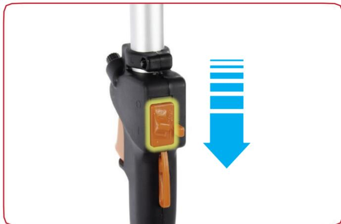
Habilite el suministro de energía de la bujía poniendo el interruptor de encendido y apagado en la posición "I".
