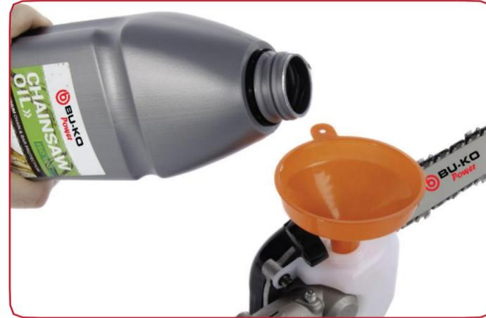
Llena el tanque con aceite de cadena. Use un embudo adecuado para ayudar a empobrecer el aceite del depósito de la cadena y evitar el derrame.
