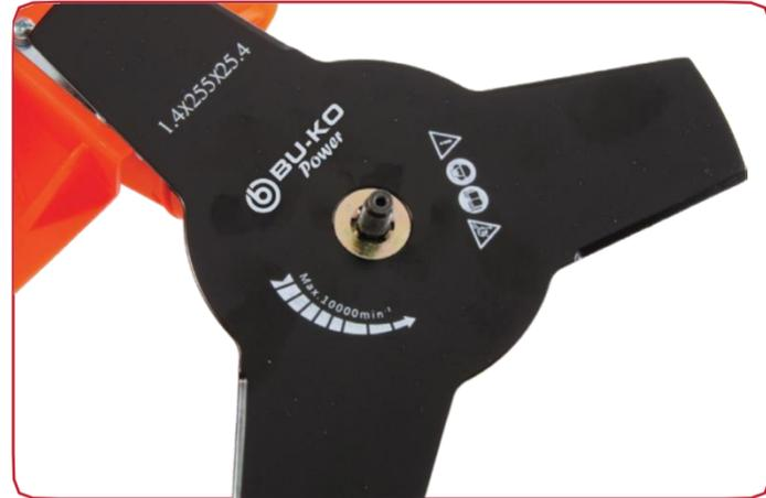
Coloca la hoja de tres dientes de manera que el agujero central esté dentro de la arandela "A". Es importante que la cuchilla esté correctamente ubicada dentro de la arandela "A" y no en una posición descentrada que pueda causar una vibración excesiva y un daño prematuro al eje inferior.
