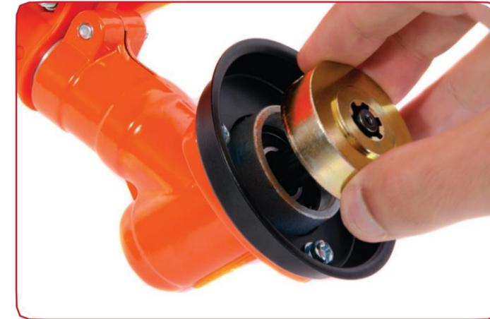
Instale la arandela "A" como se muestra arriba. Alinee la arandela con el agujero del collarín de la bobina.
