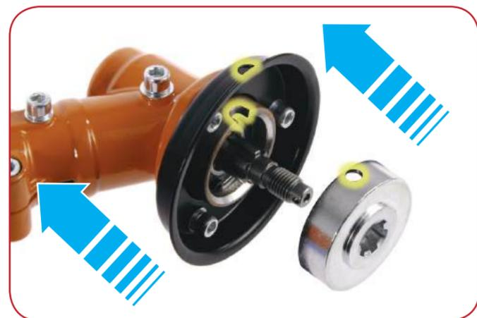
Alignez les trous sur le collier, la rondelle "A" et l'axe. Les zones mises en évidence ci-dessus.
