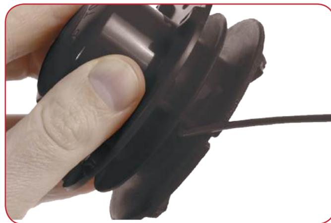
La cartouche est composée de deux enroulements qui doivent être enroulés dans le sens indiqué sur le corps. Fixez le fil de remplacement à la cartouche comme indiqué.
