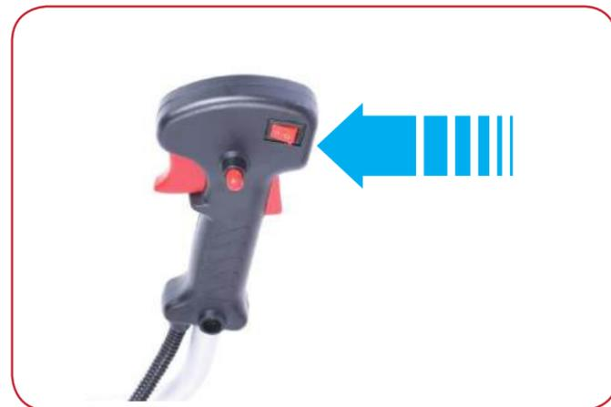
Arrêtez le moteur en plaçant l'interrupteur marche/arrêt en position "O" ou "STOP" comme illustré ci-dessus.
