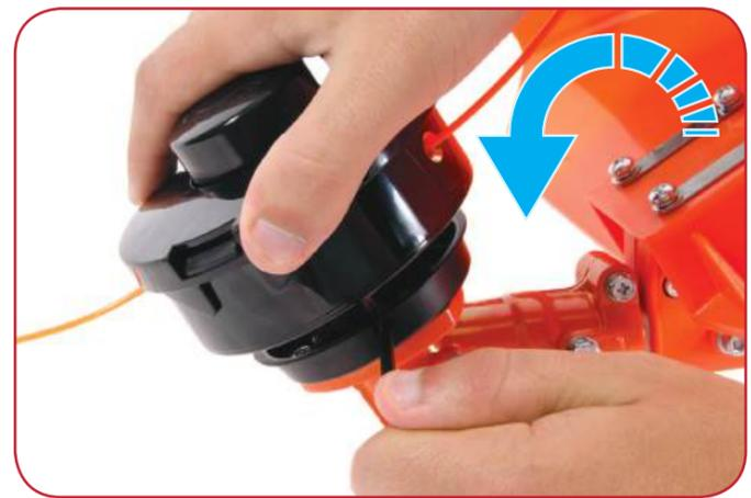
Verrouiller l'axe en plaçant la clé étrangère dans le trou de positionnement du collier et enrouler la bobine sur le fil en tournant dans le sens inverse des aiguilles d'une montre.
