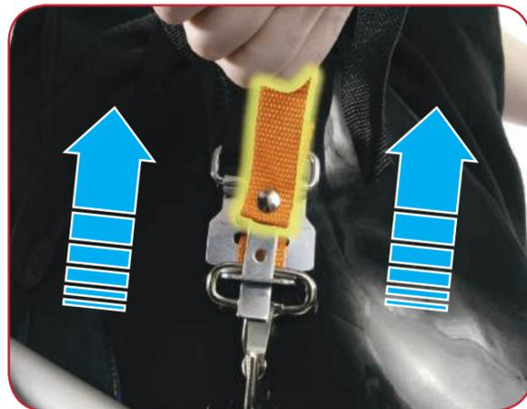
Fixez et détachez facilement la machine du harnais à l'aide du crochet à dégagement rapide.
