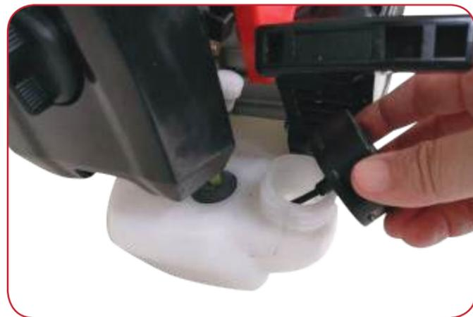
Retirez le bouchon du réservoir de carburant et remplissez le réservoir à 80 % au maximum.
