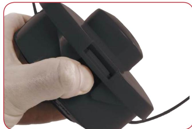
Ouvrez la bobine en appuyant sur l'un des deux clips pour desserrer le couvercle. Une fois le couvercle desserré, appuyez fermement sur le deuxième clip et retirez la cartouche de la bobine de l'intérieur du boîtier.
