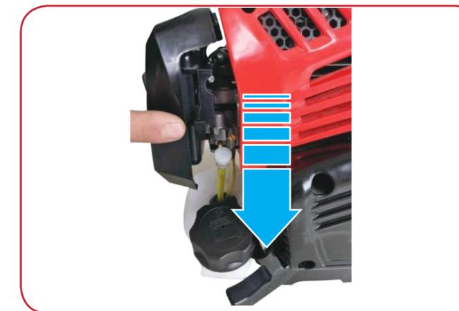
Pour les démarrages à chaud, ouvrez le starter en faisant glisser le levier vers le bas.
