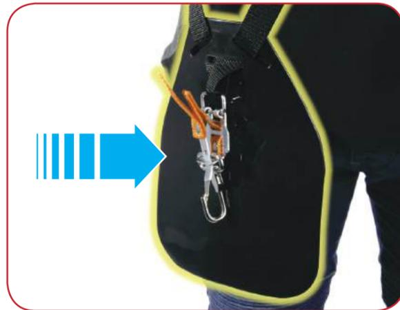
Veillez à ce que le coussin de cuisse soit placé dans la bonne position afin qu'il vous protège entièrement des points de pression créés par le contact avec la machine pendant l'utilisation.
