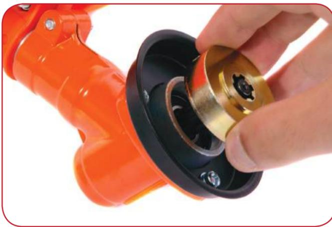
Installez la rondelle "A" comme illustré ci-dessus. Alignez la rondelle avec le trou sur le collier de la bobine.
