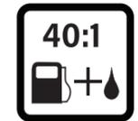
Proporción de la mezcla de combustible y aceite del motor.
