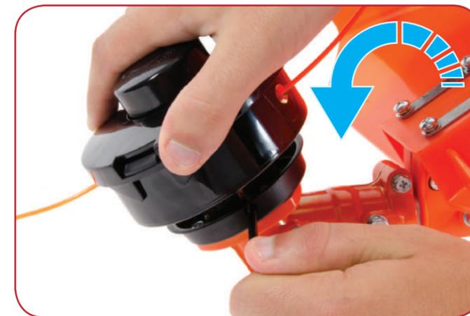
Bloquee el eje colocando la llave alienígena dentro del orificio de fijación del collarín y enrolle el carrete en el hilo girando en sentido contrario a las agujas del reloj.
