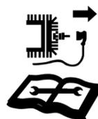
**RETIRE EL CABLE DE LA BUJÍA ANTES DEL MANTENIMIENTO**
