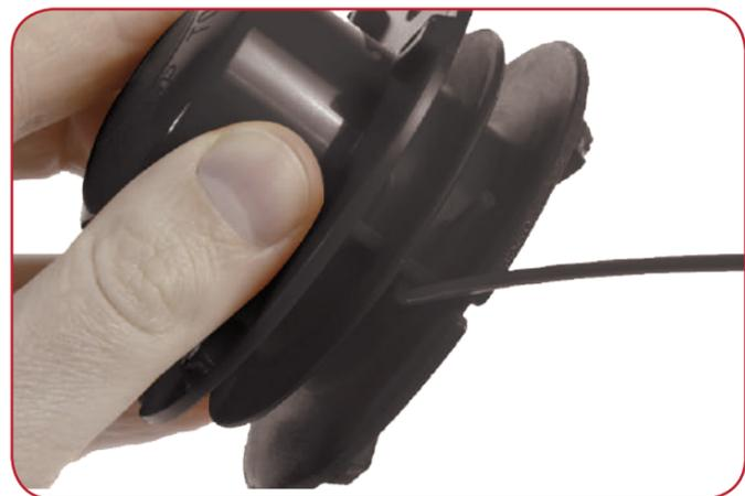
El cartucho consta de dos bobinas que deben enrollarse en la dirección indicada en el cuerpo. Fije el cable de repuesto al cartucho como se indica.
