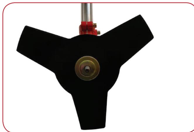
Instale la arandela "B" como se ilustra arriba para asegurar la cuchilla al eje
