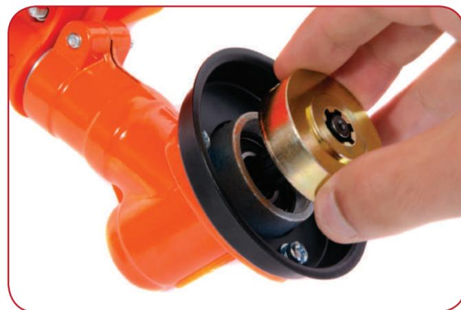
Instale la arandela "A" como se ilustra arriba. Alinee el orificio de la arandela con el orificio del collarín del carrete.
