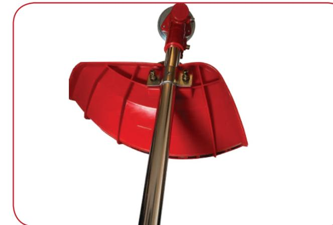
Coloque la protección en el eje inferior utilizando los 2 tornillos suministrados.
