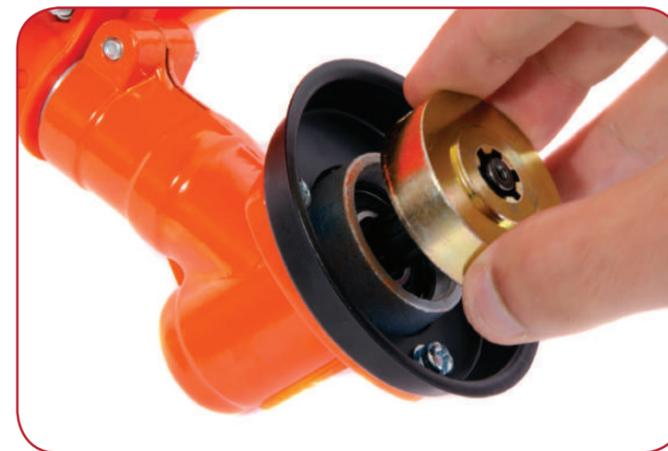
Instale la arandela "A" como se ilustra arriba. Alinee la arandela con el orificio del collarín del carrete.
