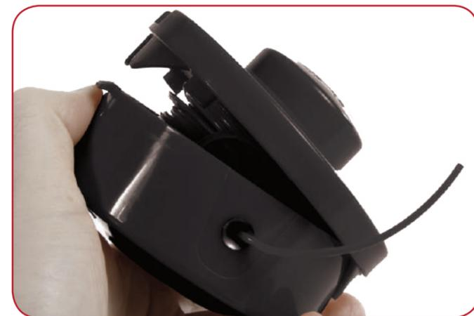
Repita los pasos 2 y 3 para la segunda bobina y vuelva a pasar el hilo por los ojales. Asegure la cubierta repitiendo el 'Paso 1' a la inversa.
