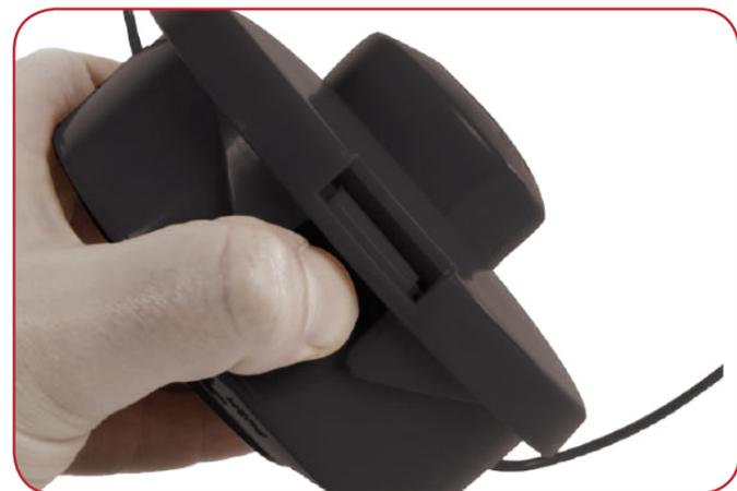
Abra el carrete presionando uno de los dos clips para aflojar la tapa. Una vez suelta, presione firmemente el segundo clip y extraiga el cartucho de la bobina del interior de la carcasa.
