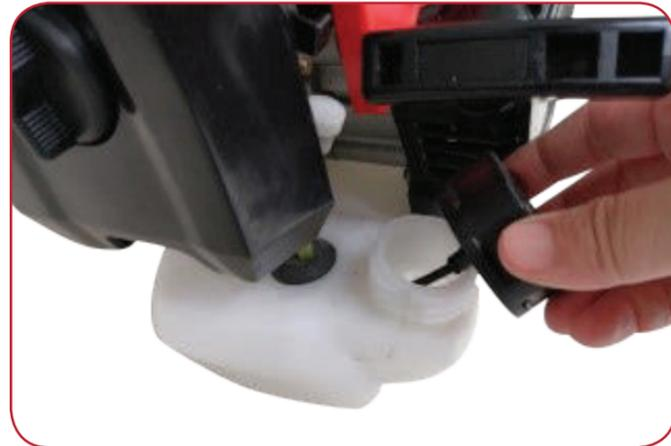
Retire el tapón de combustible y llene el depósito hasta un máximo del 80% de su capacidad.
