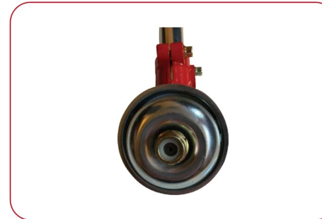
Le rondelle di bloccaggio possono essere preinstallate sul mozzo della macchina.
