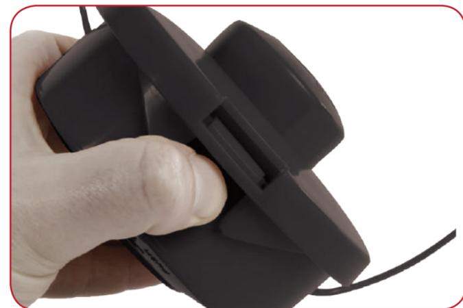
Aprire la bobina premendo una delle due clip per allentare il coperchio. Una volta allentato, premete fermamente la seconda clip e rimuovete la cartuccia del rocchetto dall'interno dell'alloggiamento.
