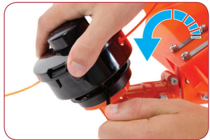
Bloccare l'asse mettendo la chiave aliena nel foro di localizzazione del collare e avvolgere la bobina sul filo girando in senso antiorario.
