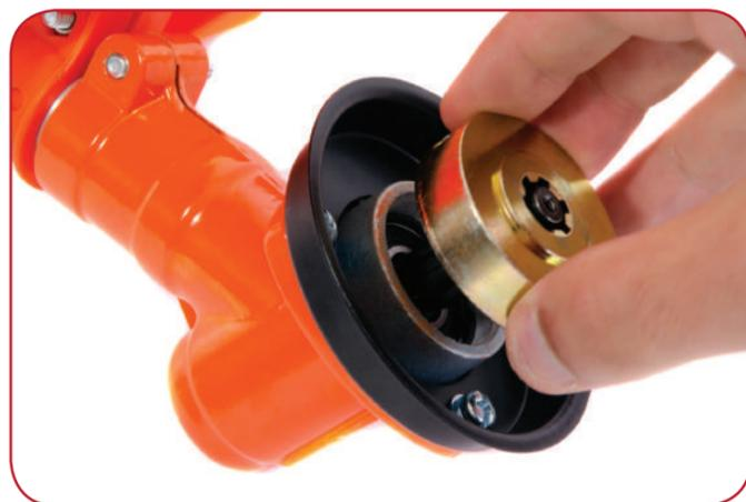
Installare la rondella "A" come illustrato sopra. Allineare il foro nella rondella con il foro nel collare del cursore.
