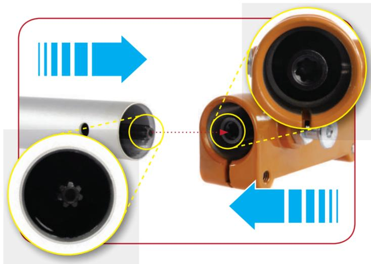
Quando si inserisce l'albero nel giunto, prestare particolare attenzione alle scanalature all'interno dell'albero.
