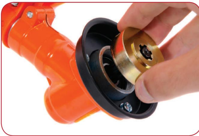
Installare la rondella "A" come illustrato sopra. Allineare la rondella con il foro sul collare del cursore.
