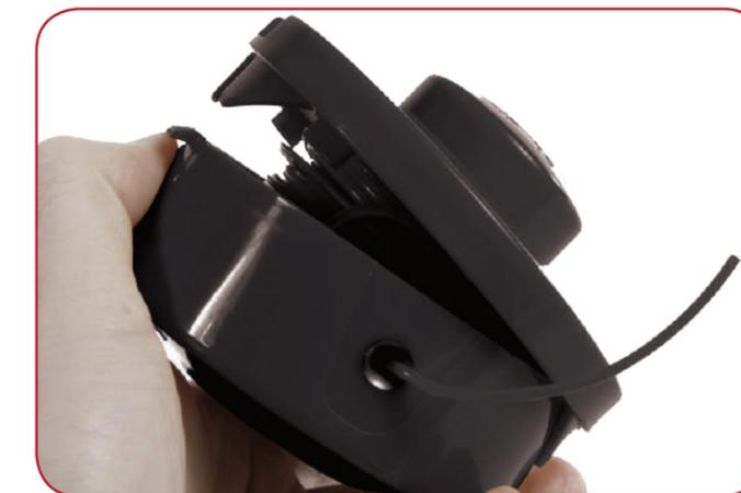
Ripetere i passi 2 e 3 per il secondo avvolgimento e infilare di nuovo attraverso gli occhielli. Fissare la copertura ripetendo il 'Passo 1' al contrario.
