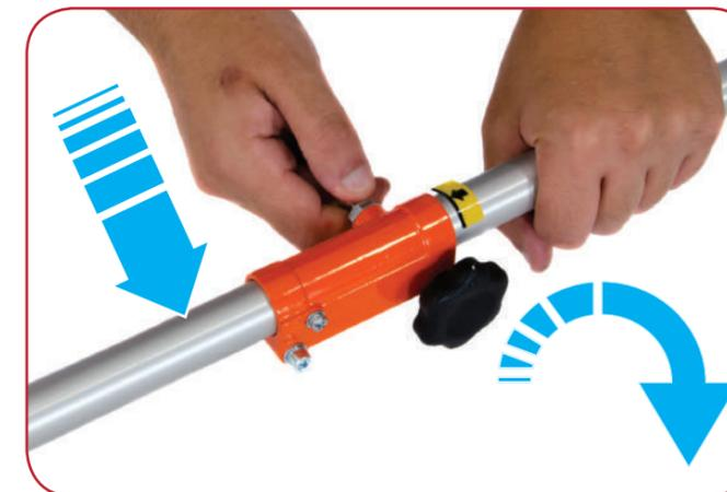
Rilasciare il perno e ruotare l'albero inferiore fino a quando il giunto è bloccato in posizione.
