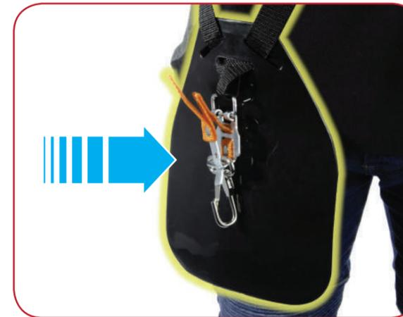
Assicuratevi che il supporto per le cosce sia posizionato correttamente in modo da proteggervi completamente dai punti di pressione creati dal contatto con la macchina durante l'uso.
